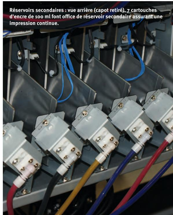
Réservoirs secondaires : vue arrière (capot retiré). 7 cartouches d'encre de 100 ml font office de réservoir secondaire assurant une impression continue.
